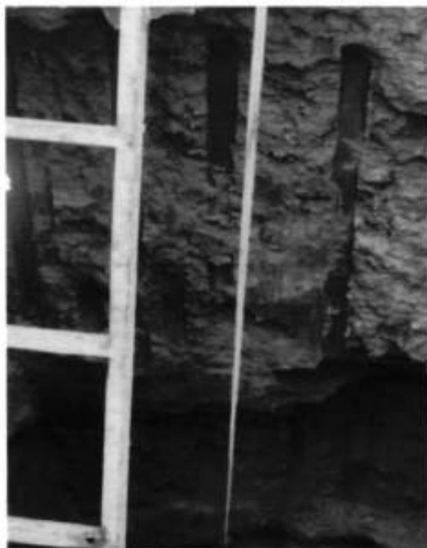
Foto 02: Estrato N° 2: Limo cohesivo (0.5-2.1 m)
