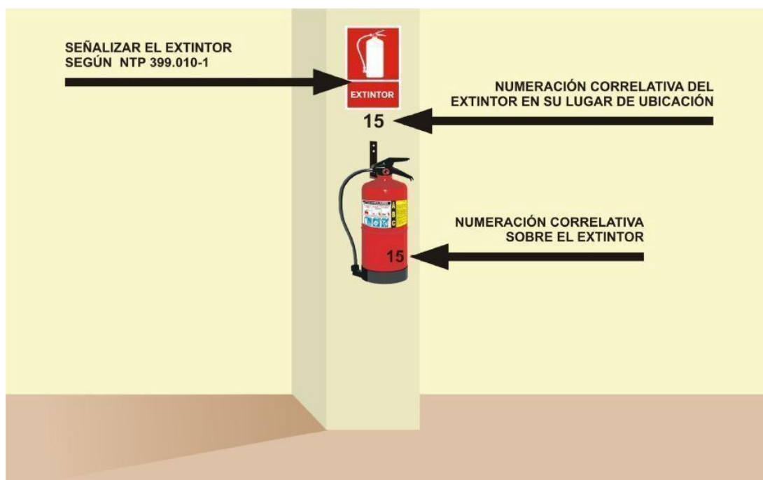
FIGURA 3: Señalización del extintor en oficinas
