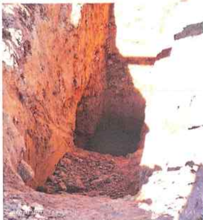
FOTO N°01: PRESENCIA DE NIVEL FREATICO EN CALICATA
