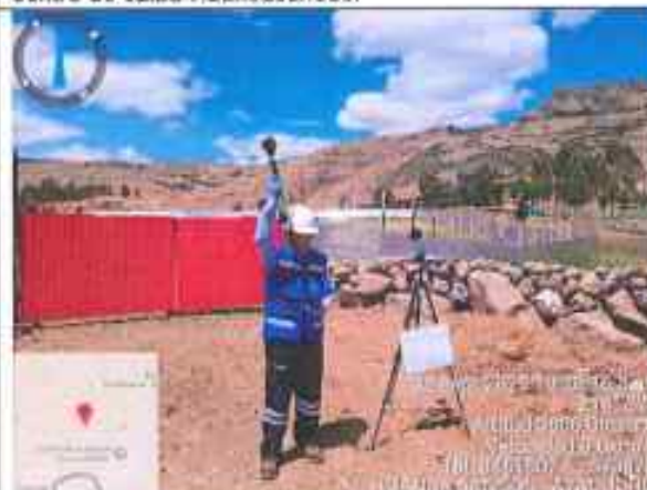
Fotografía N° 034: verificación del monitoreo de la calidad de ruido ambiental diurno en el punto 1 dentro del área de intervención del centro de salud Huancasancos.
