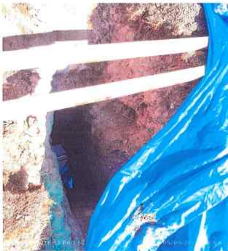
FOTO N°03: PRESENCIA DE NIVEL FREATICO EN CALICATA
