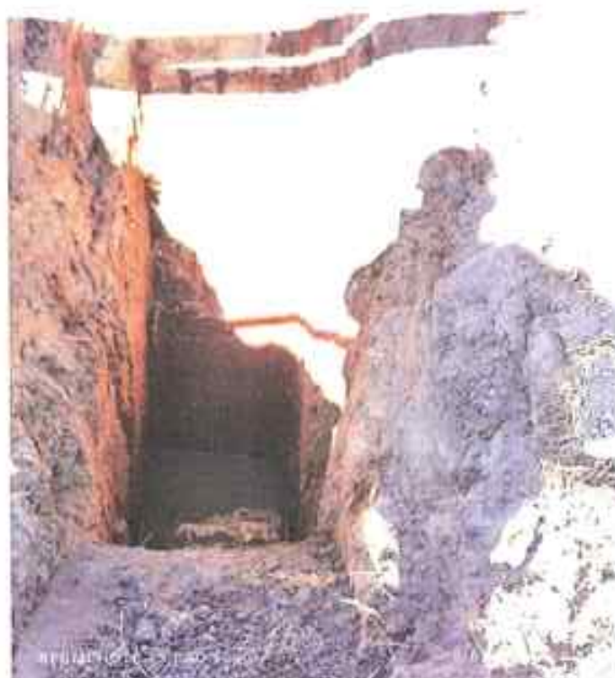
FOTO N°02: PRESENCIA DE NIVEL FREATICO EN CALICATA
