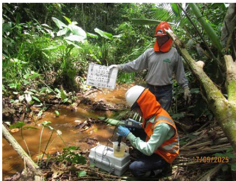
FIGURA 10: MEDICIÓN DE PARÁMETROS IN SITU DE CALIDAD DE AGUA
