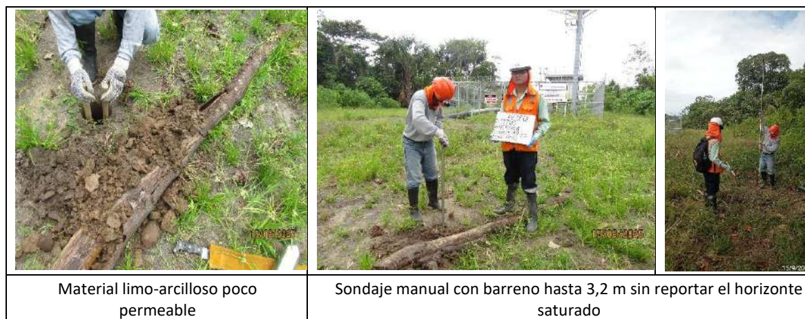
FIGURA 8: SONDAJE MANUAL N° 1 Y N°2 PARA REGISTRAR/DESCARTAR LA PRESENCIA DE AGUA SUBTERRÁNEA EN EL ÁREA DE ESTUDIO
