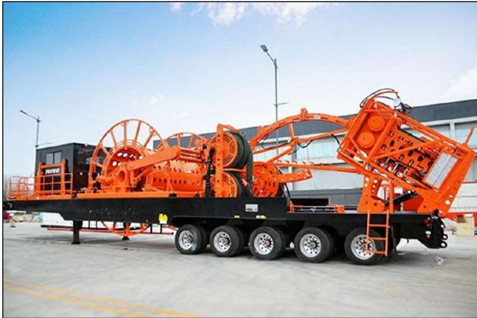
FIGURA 84: EQUIPO DE COILED TUBING PARA INYECCIÓN DE CEMENTO
