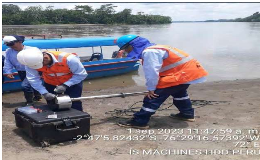
Imagen 08.- Preparación de Ecosonda multihaz MS400U para levantamiento batimétrico Fuente: Propia
