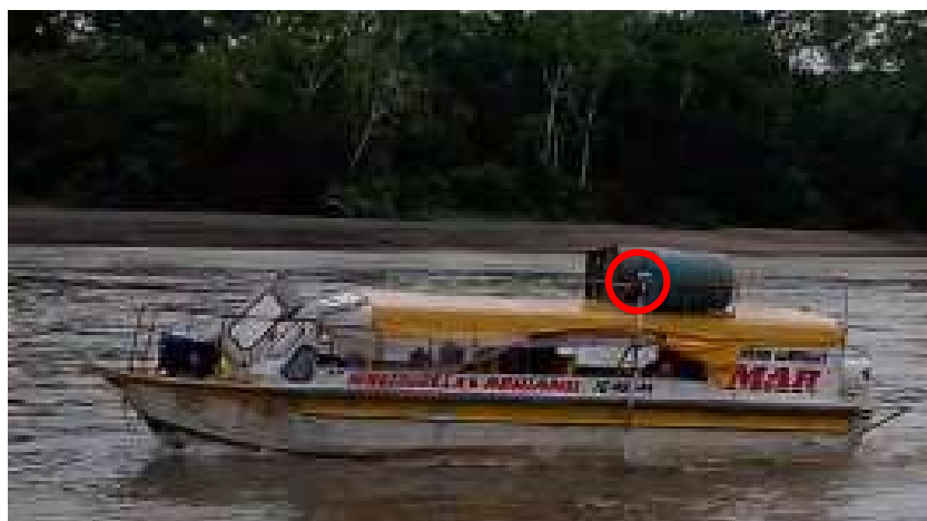
Imagen 09.- Embarcación hidrográfica con del GPS rover para el levantamiento batimétrico Fuente: Propia
